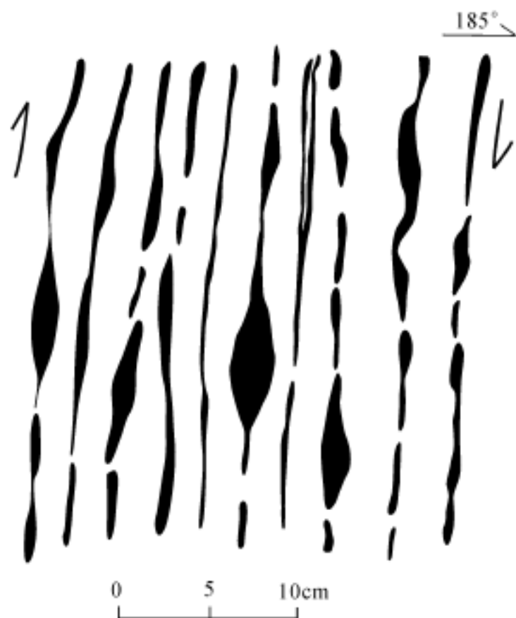
图 2-13 日阿-领布冲韧性剪切带中长英质脉体呈拔丝状、眼球状构造剖面素描图
