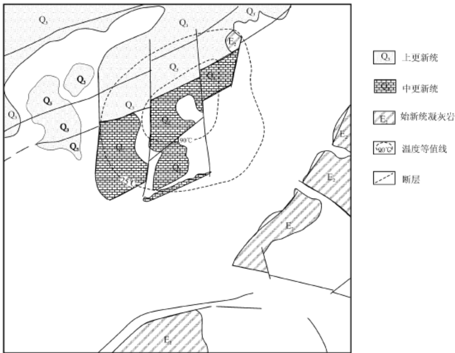
图 6-30 拉多岗地热田地温分布图 (据梁廷立、多吉等，1995)
