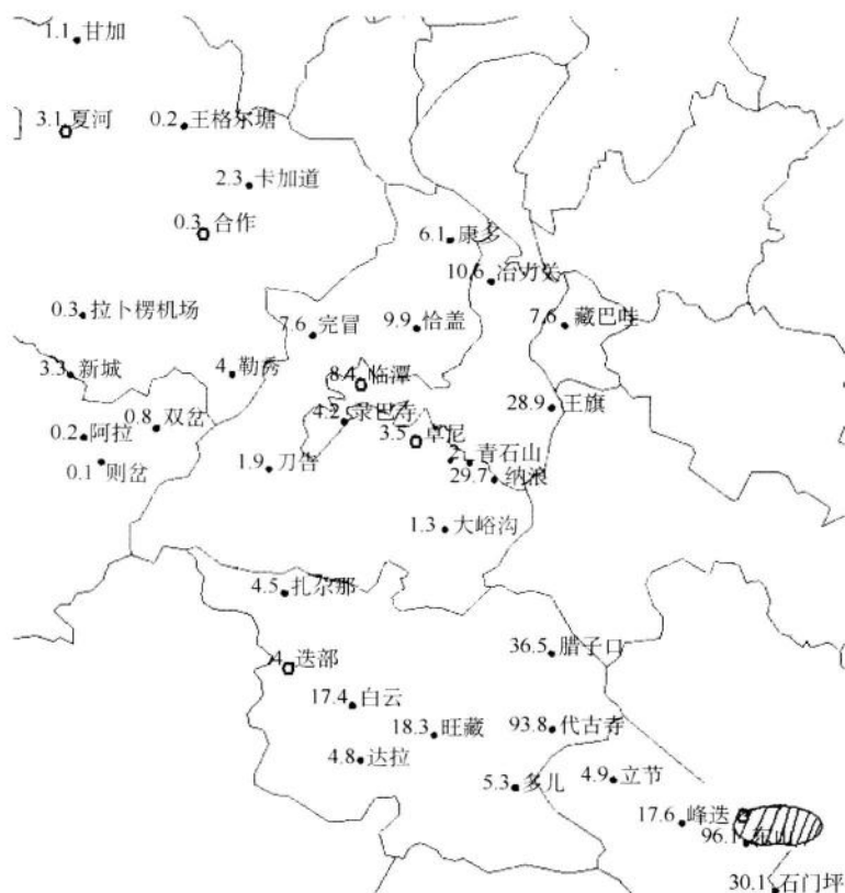
图1 甘南地区观测站点、8月7日20时至8月8日04时降水量及泥石流发生区域分布图
