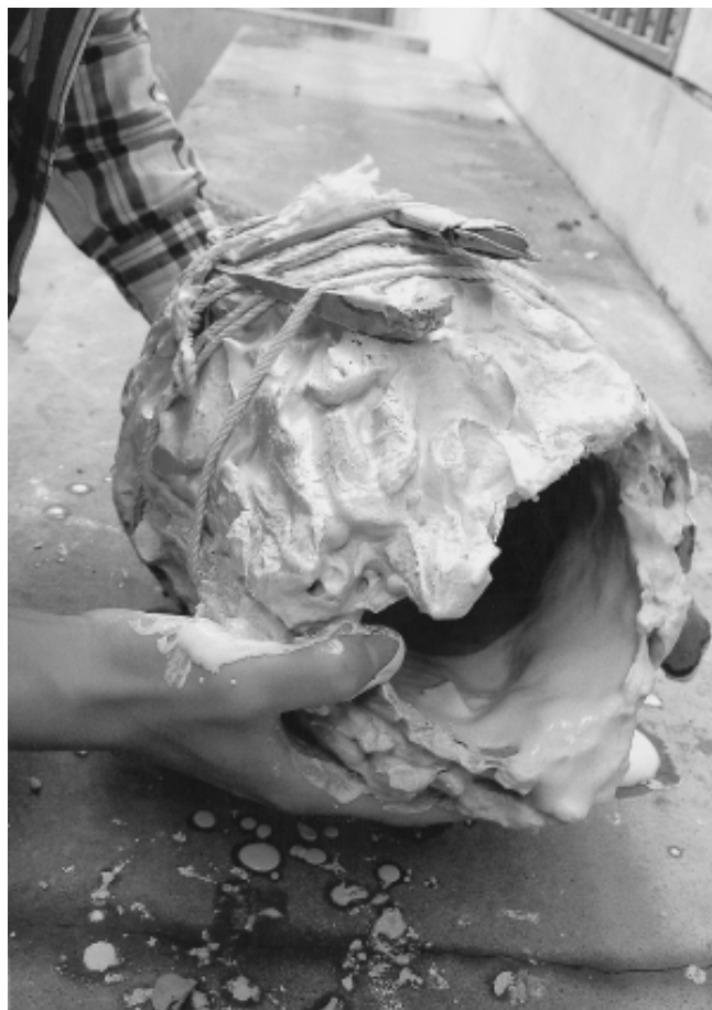
图 5-1-11 翻转模具，让石膏浆附着在四壁
