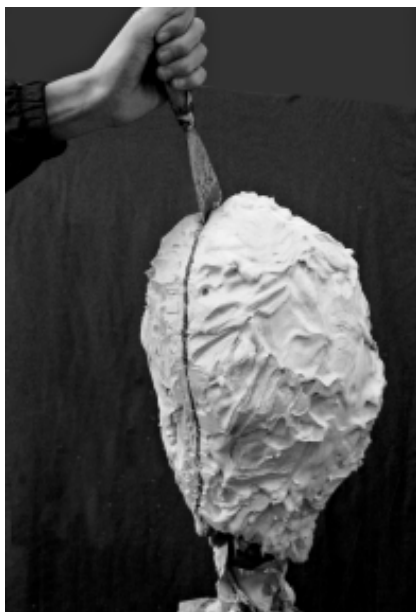
图 5-1-6 清理接缝,用铲刀插入缝隙,分离两块模
