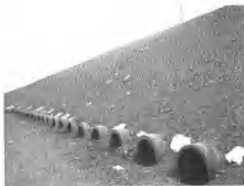
图3 通风管试验路基
