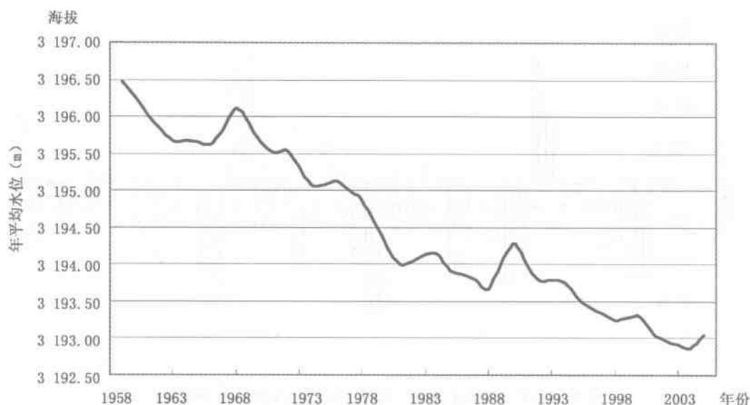
图 2-4-5 青海湖 1959~2005 年平均水位变化过程线 (二郎剑水位站)
