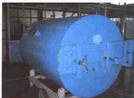
图 15.5 BSP 公司客车车窗气囊选材试验装置
