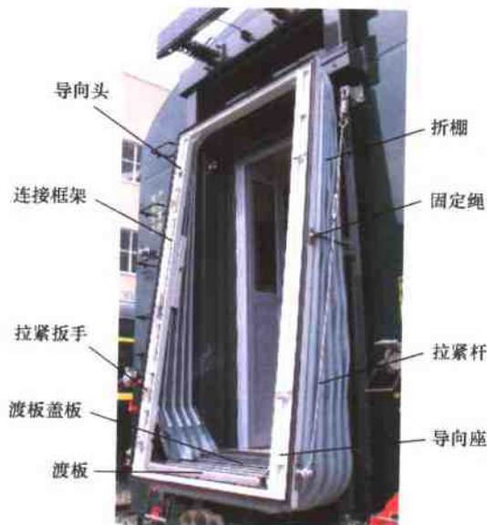
图 6.10 密封式折叠风挡
