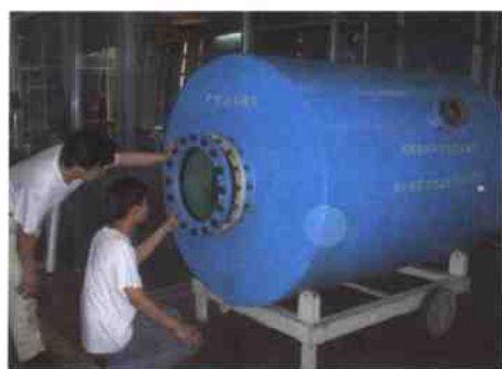
图 15.5 BSP 公司客车车窗气囊选材试验装置
