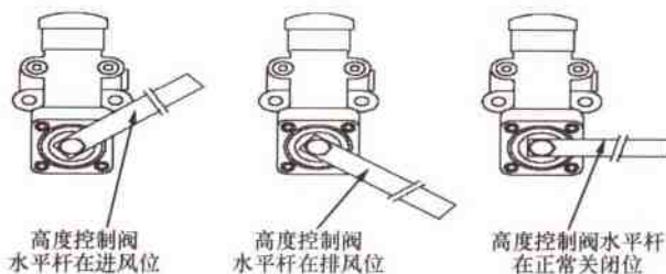
图 4.12 高度控制阀控制杆的作用位置
