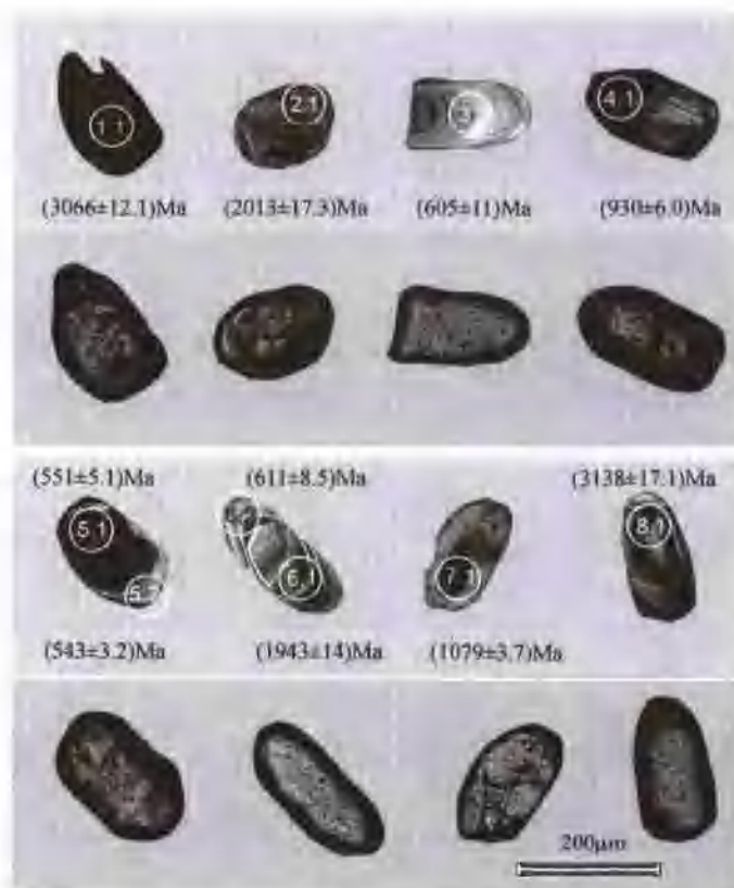
图 1-3-29 榴辉岩的围岩含石榴子石石英片岩(06Y-525)中锆石的特征和 SHRIMP U-Pb 定年
