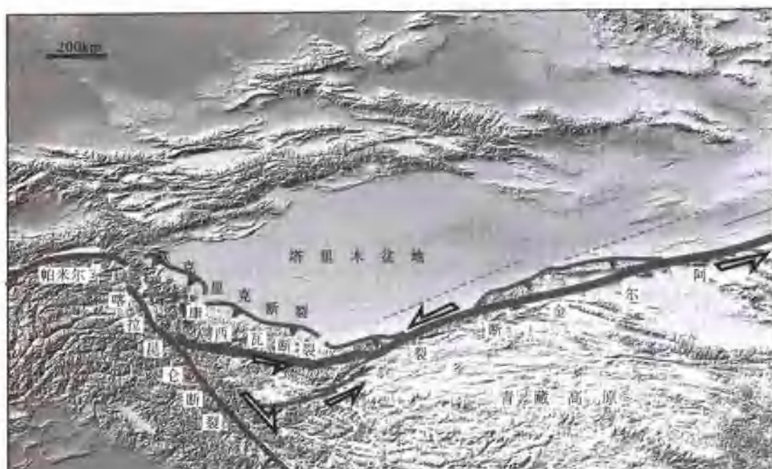
图 1-7-2 阿尔金韧性左行断裂与康西瓦韧性左行断裂在 110~120Ma 开始连接
