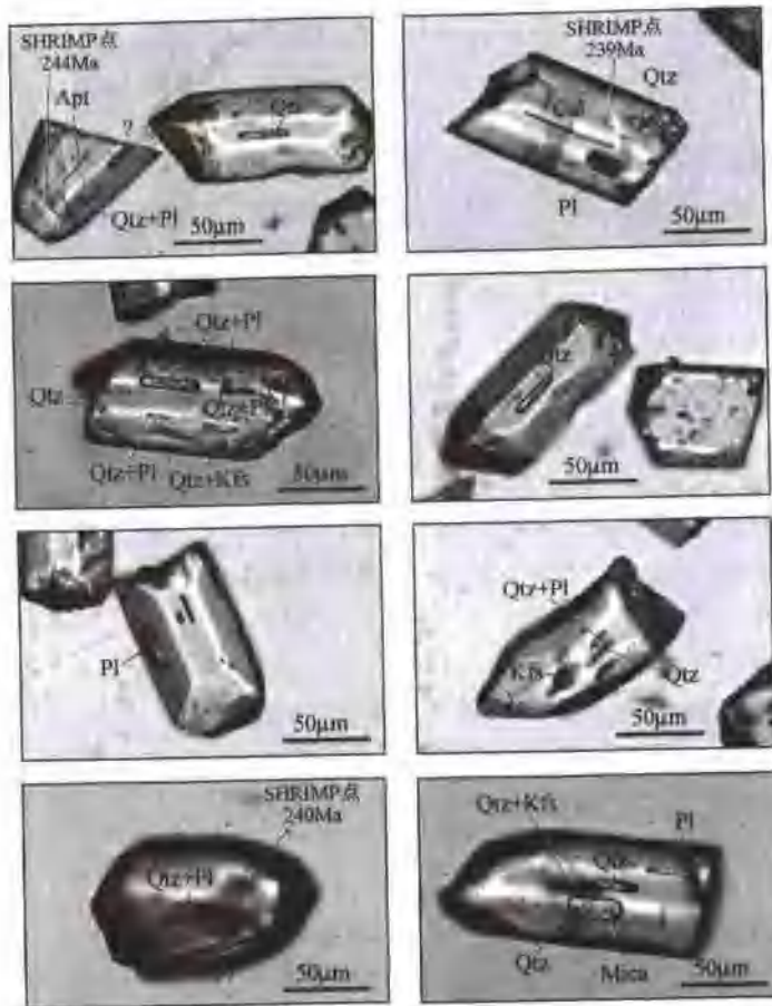
图 I-7-49 糜棱岩中柱状锆石的阴极发光图像及 SHRIMP U-Pb 年龄
