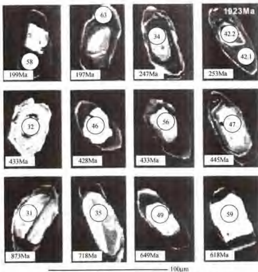
图 I-1-26 康西瓦孔兹岩系 KXW30-36 号样品锆石 SHRIMP 测试背散射及显微照片
