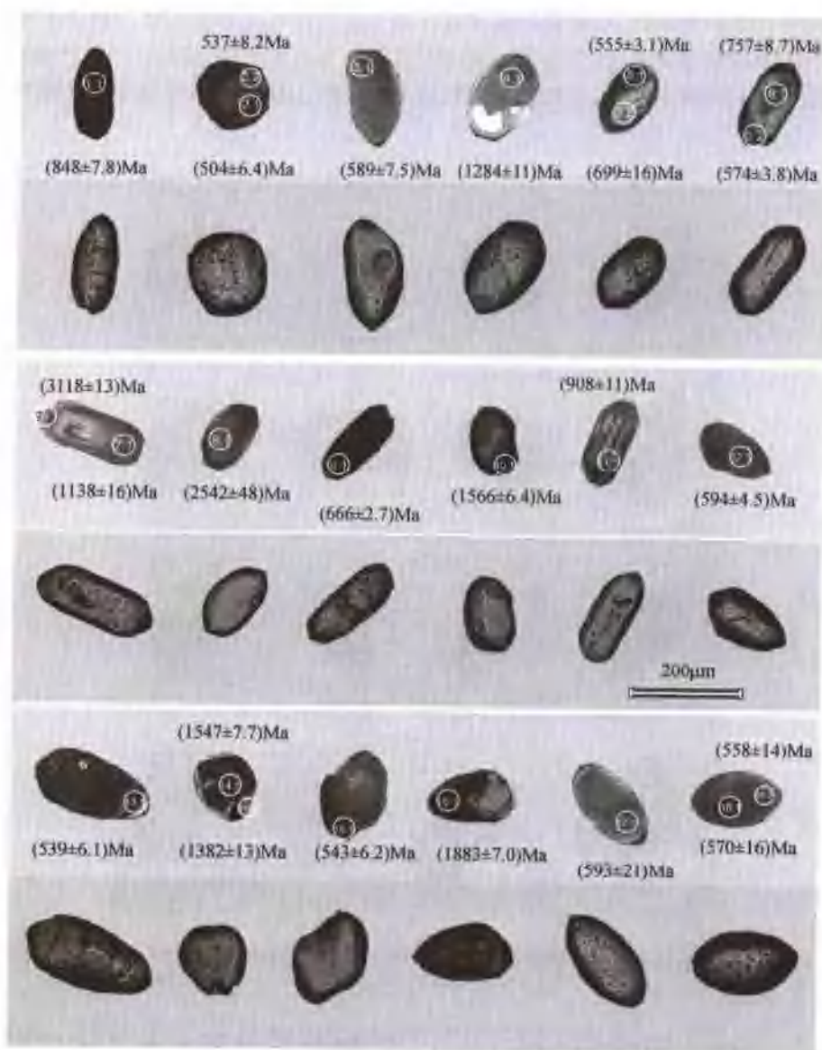
图 1-3-27 榴辉岩的直接围岩含石榴子石云母石英片岩(06Y-537)中锆石的特征和 SHRIMP U-Pb 定年
