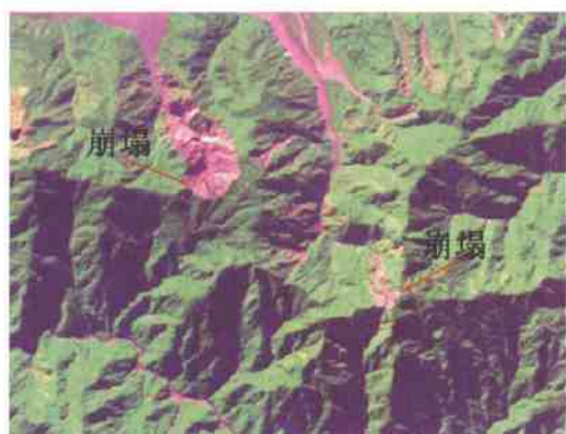
图版 5-1-3 典型崩塌遥感影像图
