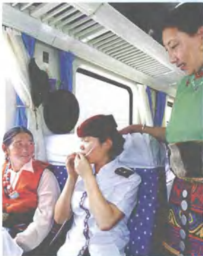
青藏列车内的管道供氧吸氧法
