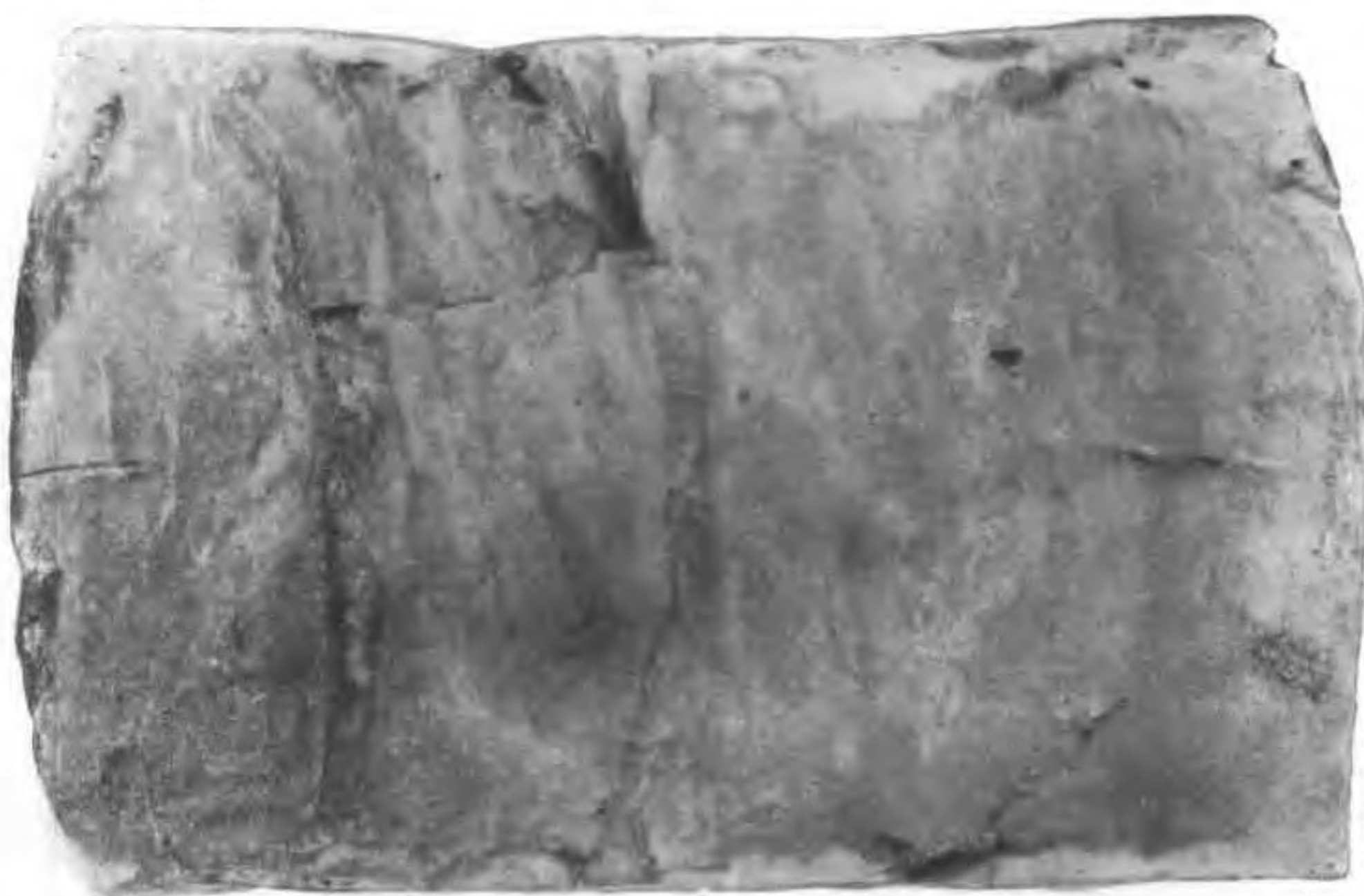
照片 69 青 4 孔 56 号岩芯 灰色泥质粉砂 可见清晰的深灰色淤泥条带, 宽 5~7 毫米, 水平产出
