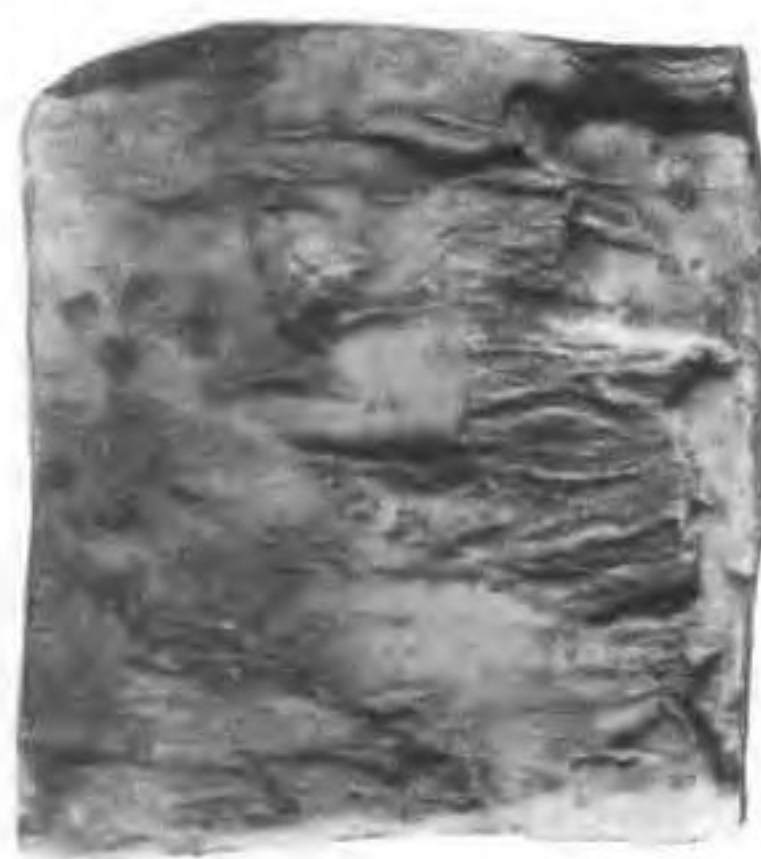
照片 62 青 4 孔 17 号岩芯 深灰色粉砂质 粘土淤泥, 可见水平层纹及黑色炭质条痕
