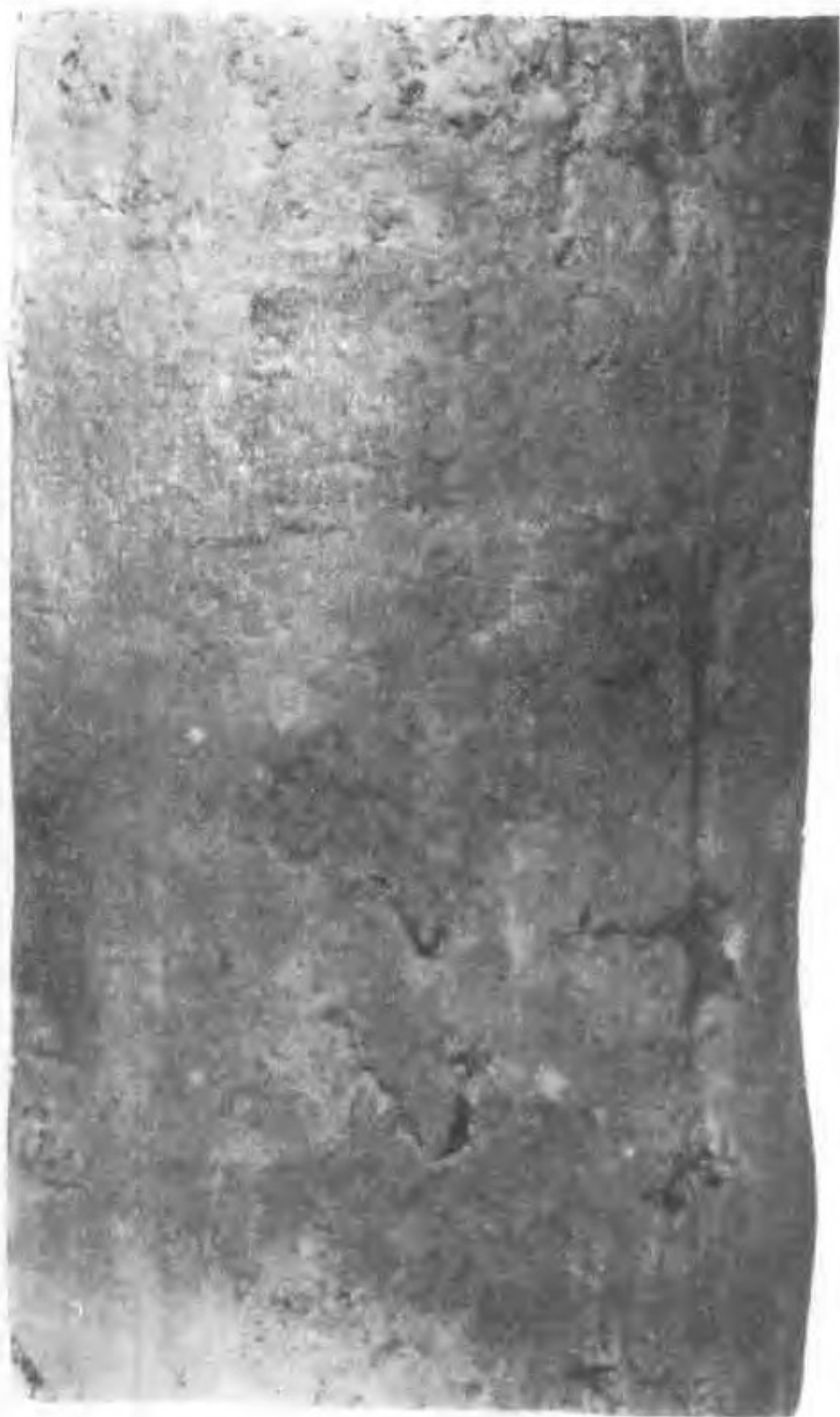
照片 74 青 5 孔 54 号岩芯 第四纪早—中更新世黄土
