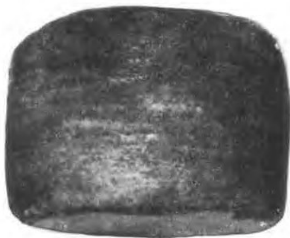
照片 73 青 4 孔 78 号岩芯 黄褐色钙质胶结细砂岩(第四纪沉积物中的局部胶结层)
