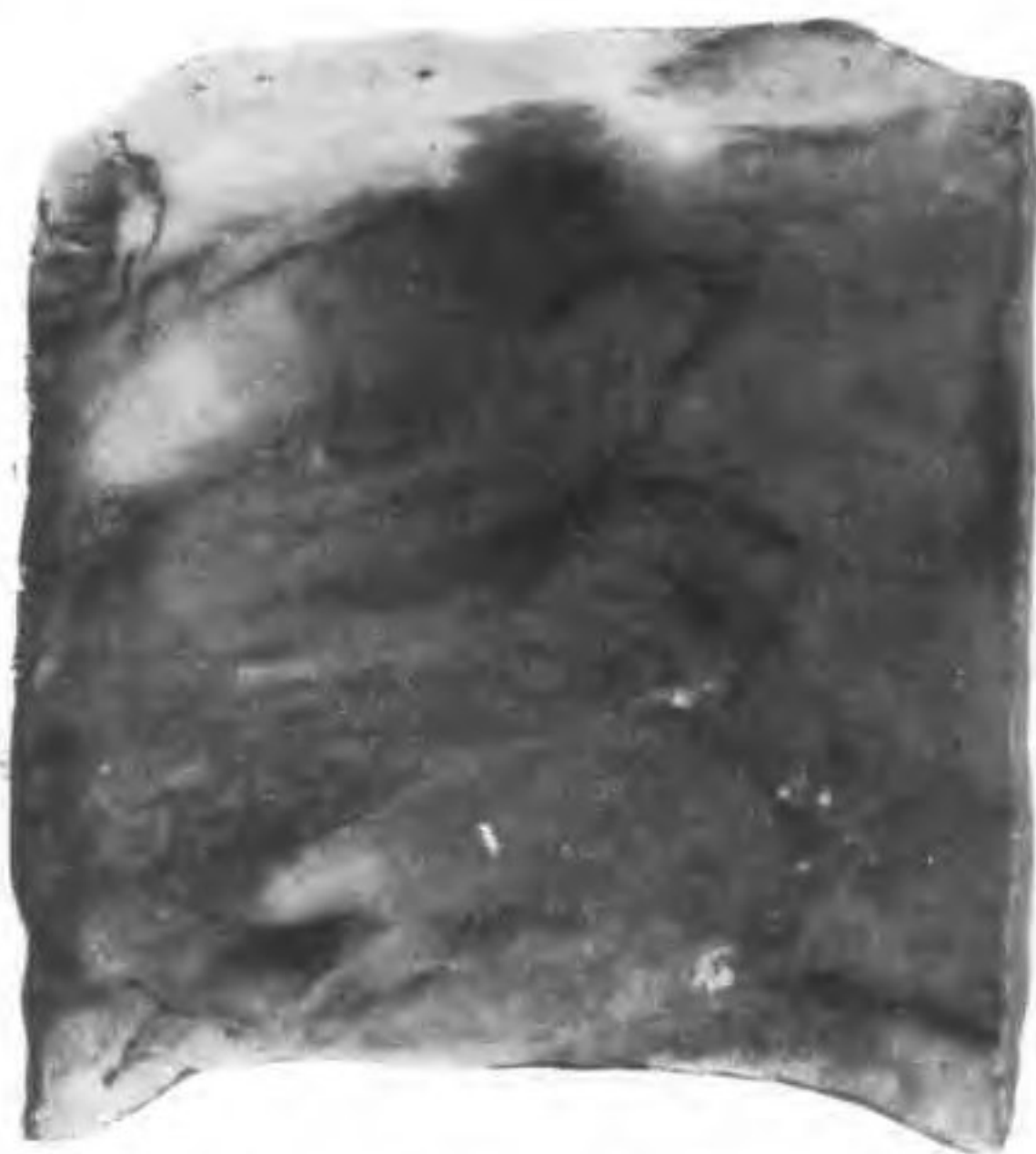
照片 72 青 4 孔 90 号岩芯 深灰黑色粘土淤泥。砂—粉砂随埋藏加深显微结构的变化(正交偏光, \times 80 )
