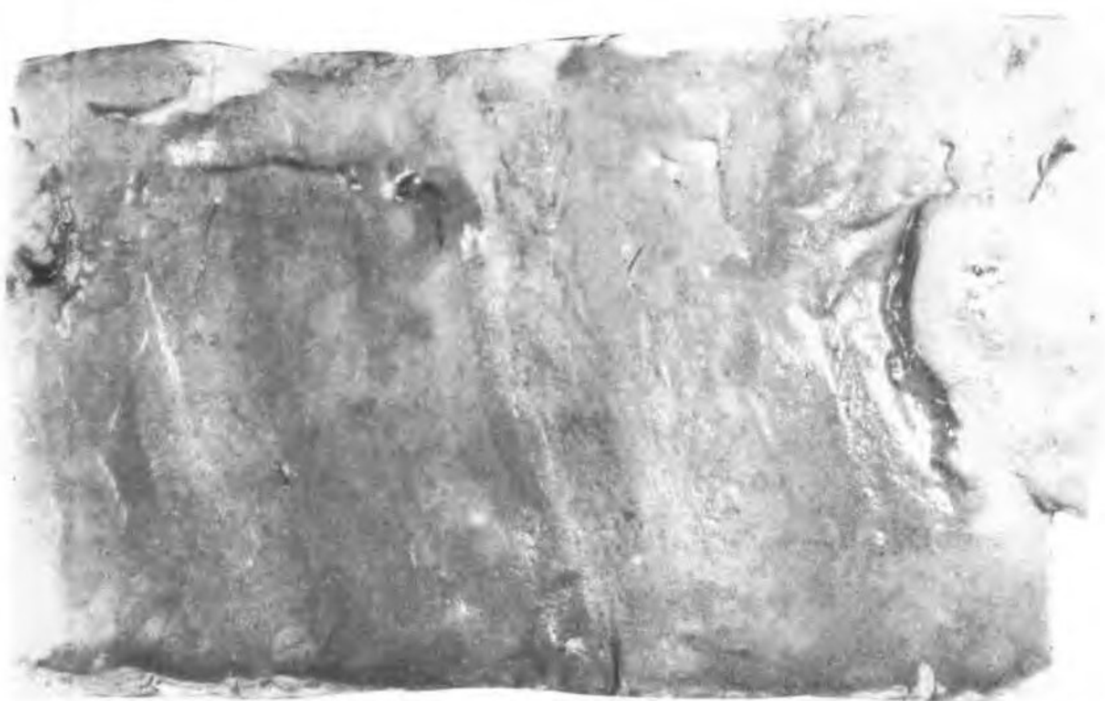
照片 70、71 青 4 孔 60 号岩芯 灰黑色粉砂质淤泥; 可见清晰的粘土淤泥水平条带, 照片右上角黑色斑块是黄铁矿小结核, 不规则状, 大小 8 毫米 (照片 71 是照片 70 的放大)
