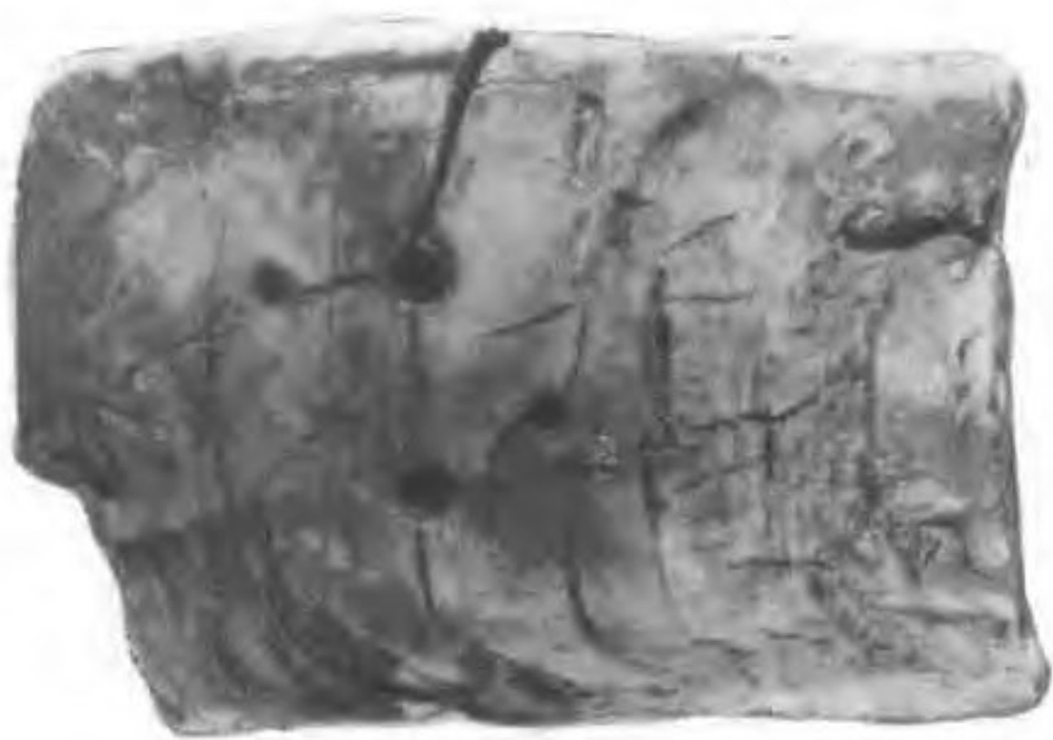
照片 66、67 青 4 孔 34 号岩芯 浅灰色粉砂质淤泥 斑点、斑块。五个小洞是现场测定 \gamma_{\text{H}} 值时留下来的插孔
